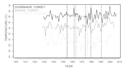
Mittlere Juli Maximum-Temperaturen vor (gestrichelte Linie) und nach der Homogenisierung (durchgezogene Linie) für drei Stationen im östlichen Mittelmeerraum. Die gestrichelten vertikalen Linien kennzeichnen Brüche der jeweiligen Zeitreihe, welche mit Hilfe der Maximum-Likelihood-Methode ermittelt wurden. (Bearbeitung: Franz Kuglitsch)
