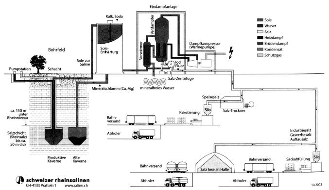
Abb. 1: Produktionsschema (Quelle: http://www.saline.ch/downloads/dokumente/)
