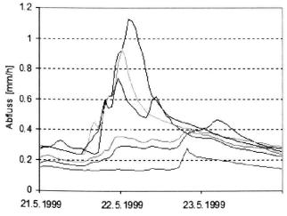
Abbildung 2: Abflussganglinien (Beobachtung und Simulationen mit unterschiedlichen Niederschlagsinputs) der Emme bei Emmenmatt für die Hochwasserperiode 21.05.–23.05.1999 unter Verwendung eines auf Hochwasser kalibrierten Parametersatzes.
