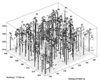
Abb. 1: 3D-Rekonstruktion der Baumgeometrie aus LIDAR-Daten (B. Allgöwer)
