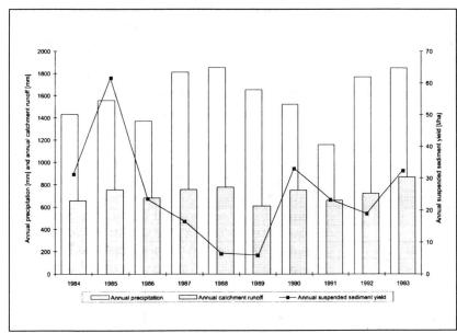
Abb. 2: Jahreswerte des Niederschlags, der Abflusshöhen und des Sedimentaustrags für das Kleineinzugsgebiet der Forschungsstation Anjeni.
