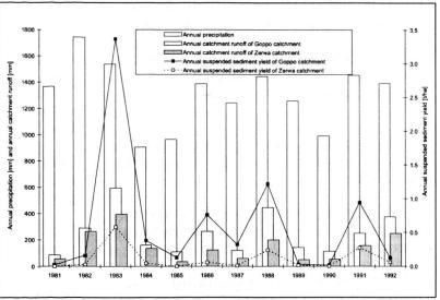
Abb. 1: Jahreswerte des Niederschlages, der Abflusshöhen und des Sedimentaustrages für die Zwillinseinzugsgebiete der Forschungsstation Gununo.
