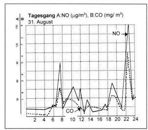
Abb. 2: Fussballspiel vom 31.8.88: Deutlich ist im Tagesverlauf die Korrelation der Messwerte von NO und CO mit der Pendlerbewegung zu sehen. Beeindruckend sind die Werte vom Ende des Matchs um 22.15 Uhr mit der Wegfahrt von 3500 Fahrzeugen mit kaltem Motor und noch unwirksamem Katalysator.
