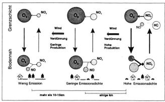
Figur 1: Schematische Darstellung des Zusammenhangs zwischen den dreidimensionalen Transport- und Umwandlungsprozessen und den bodennahen Ozon- und  $NO_2$ -Konzentrationen. Der Kreisdurchmesser entspricht der Grösse der Schadstoffkonzentration, die Pfeildicke dem Transport (entsprechend dem Konzentrationsgradienten.) Der Einfluss der Kohlenwasserstoffe wurde nur beispielhaft oben rechts dargestellt, ist aber sinngemäss überall vorhanden.
