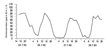
Figur 2: Absinken des Ozonmaximums am 27.7.1990 aufgrund der variablen Stabilitätsverhältnisse während der vorhergehenden Nacht (Siselen)
