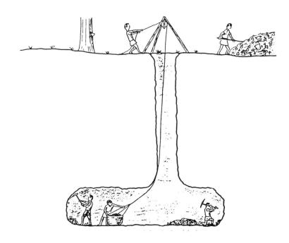
Abb. 4.: Vortrieb eines Stollens in Kanatbauweise: Arbeiten im Bereich eines Schachtes; die Verbindung einer Kette solcher Baulose ergab schliesslich das Gesamtbauwerk (Grewe 1985).
