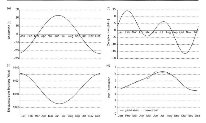
Fig. 1. Jahresgeang (a) der Deklination (Winkel zwischen Äquator und Position der Sonne), (b) der Zeitgleichung (Differenz zwischen mittlerer und wahrer Ortszeit), (c) der extraterrestrischen Strahlung und (d) des Linke-Trübefaktors (Abschwächung der Strahlung beim Durchdringen der Atmosphäre; durch Kasten et al. (1984) angegebene Messwerte sowie mit einer Fourier-Transformation berechnete Werte. Die Berechnung der dargestellten Variablen wird im Text bzw. Anhang erläutert.
