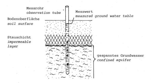
Abb. 4. Verfälschung von Grundwasserstandsmesswerten durch gespanntes Grundwasser.
