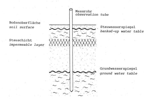
Abb. 2. Grundwasserstandsmessung in Böden mit Stauschichten.
