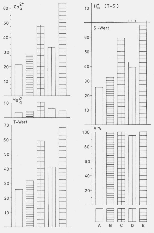
Werte für CaCO<sub>3</sub> (56% TG) und pH (7,7) verständlich erscheinen. Die Werte für austauschbares Kalzium (22,2 mval/100 g TB) und Magnesium (3,3 mval/100 g TB), ebenso der *T*- und *S*-Wert (jeweils 25,6 mval/100 g TB) sind in dieser Einheit am geringsten. Dass die Kationenumtauschkapazität gleich gross wie der *S*-Wert ist, liegt daran, dass keine austauschbaren Wasserstoffionen auftreten. Dementsprechend beträgt der Basensättigungsgrad 100%.
