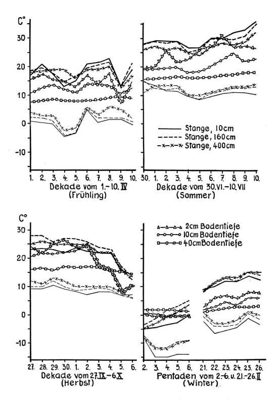
Abb. 7. Zehntägige Einzeltagsreihen der Temperatur verschiedener Jahreszeiten im Jahre 1933. Maximumwerte (dick ausgezogen) und Minimumwerte (fein ausgezogen) an der Stange, Frühnachmittagswerte (nahe dem Tagesmaximum) im Boden.
