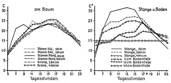
Abb. 9. Ganztagsablesung der Temperatur am 29. Mai 1934, am Baum, an der Stange und im Boden, in zweistündigem Intervall.
