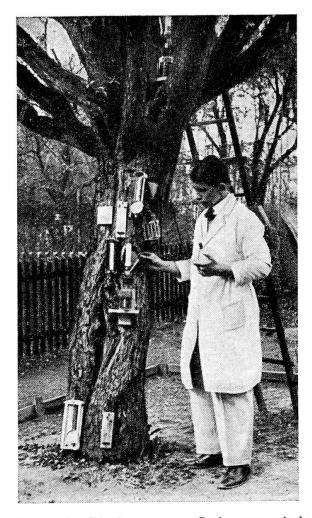
Abb. 2. Stamm des Birnbaumes von Südwesten mit den Instrumenten: unten Thermometer und Hygrometer, oben in der unteren Reihe Atmometer und Photometer, in der oberen Reihe Thermometer, Hygrometer, Tauplatte und rechts außen Einrichtung zum Messen des Wasserabflusses längs des Stammes. Ganz oben Atmometer in der Kronenbasis. Photo Frühling 1933.
