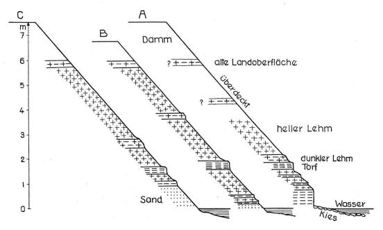
Abb. 5. Uferprofile der Broye zwischen Avenches et Payerne mit den herausgewitterten Bänken von Torf und schwarzem Lehm (schematisch).
