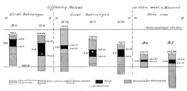
Abb. 2. Stratigraphische Profile des Untergrundes des Melide-Dammes. Bohrungen mit Torfeinlagerungen.
