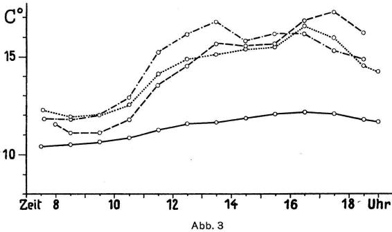
Mikroklimatisches Höhenprofil am Jakobshorn (Davos). Temperaturen in 2 cm Bodentiefe. Erklärung der Zeichen siehe Abb. 1.
