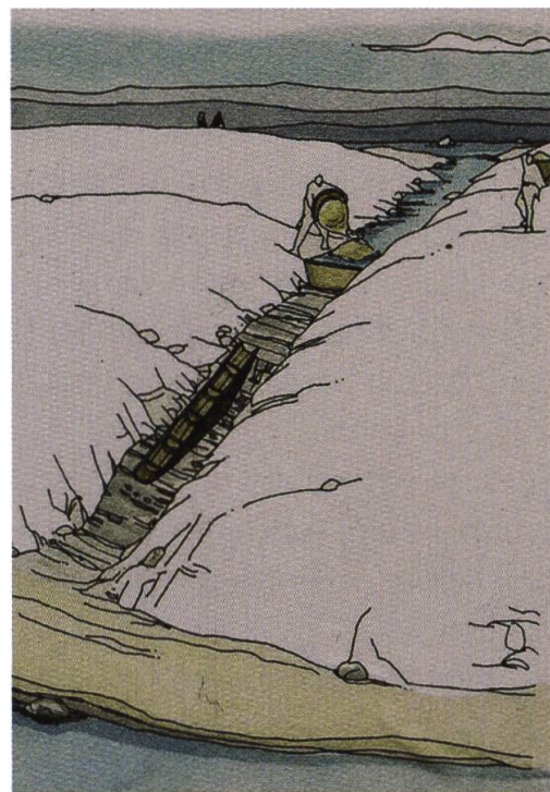
Durch das Öffnen der gestauten Wasserkanäle wurde der von den grossen Steinen getrennte, goldhaltige Sand über einen Holzkanal gespült
