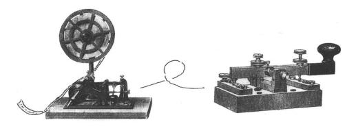
Telegraphen-Apparatur: links Schreibapparat = Empfänger, rechts Morse-Taster = Sender
