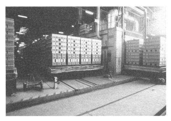
Tunnelofen: von rechts fahren die Rohlinge automatisch in den Ofen
