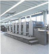
Links: Die Vorstufenabteilung kurz vor dem Einzug Rechts: Die Offsetdruckmaschine Speedmaster 74-5-P+L ist mit einem Lackwerk ausgerüstet
