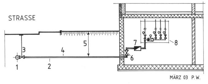
Querschnitt durch die Hausanschlussleitung: 1. Hauptleitung, 2. Hausanschlussleitung, 3. Absperrorgan, 4. Leitungsdurchmesser min.  $1\frac{1}{4}$ , 5. Überdeckung ca. 1,1 m, 6. Absperrorgan, 7. Wasserzähler, 8. Verteilbatterie
