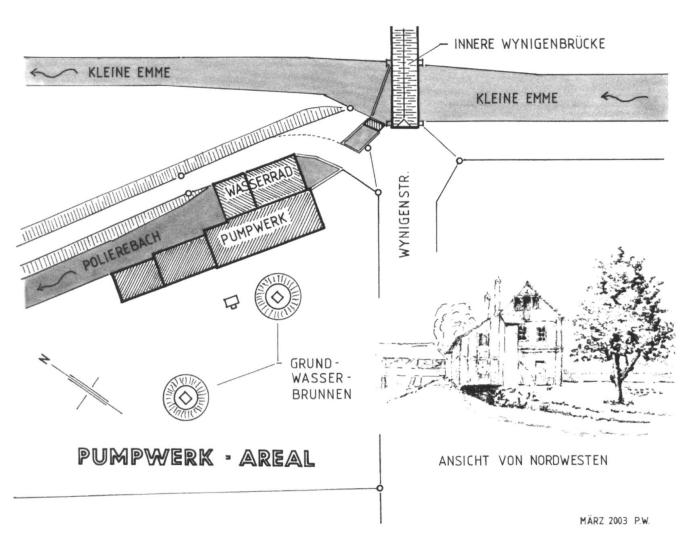
Links ist der Grundriss der Pumpwerkanlage von 1897 mit den zwei Grundwasserbrunnen zu sehen. Einer der beiden Brunnen ist erhalten geblieben und 1981/82 beim Bau des Schulpavillons restauriert worden
