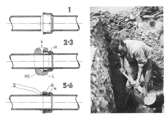
Erstellen einer Stemmmuffe: 1. freies Rohrende in Glockenmuffe einführen; 2. Hanfstrick H einstemmen; 3. mit Lehmkranz L den Hanfstrick HS anbringen, welcher durch das Herausziehen einen Hohlraum für das Blei hinterlässt; 4. flüssiges Blei einfüllen, erkalten lassen; 5. Lehmkranz entfernen; 6. noch weiches Blei mit Stemmeisen S in die Muffe schlagen und überflüssiges Blei entfernen
