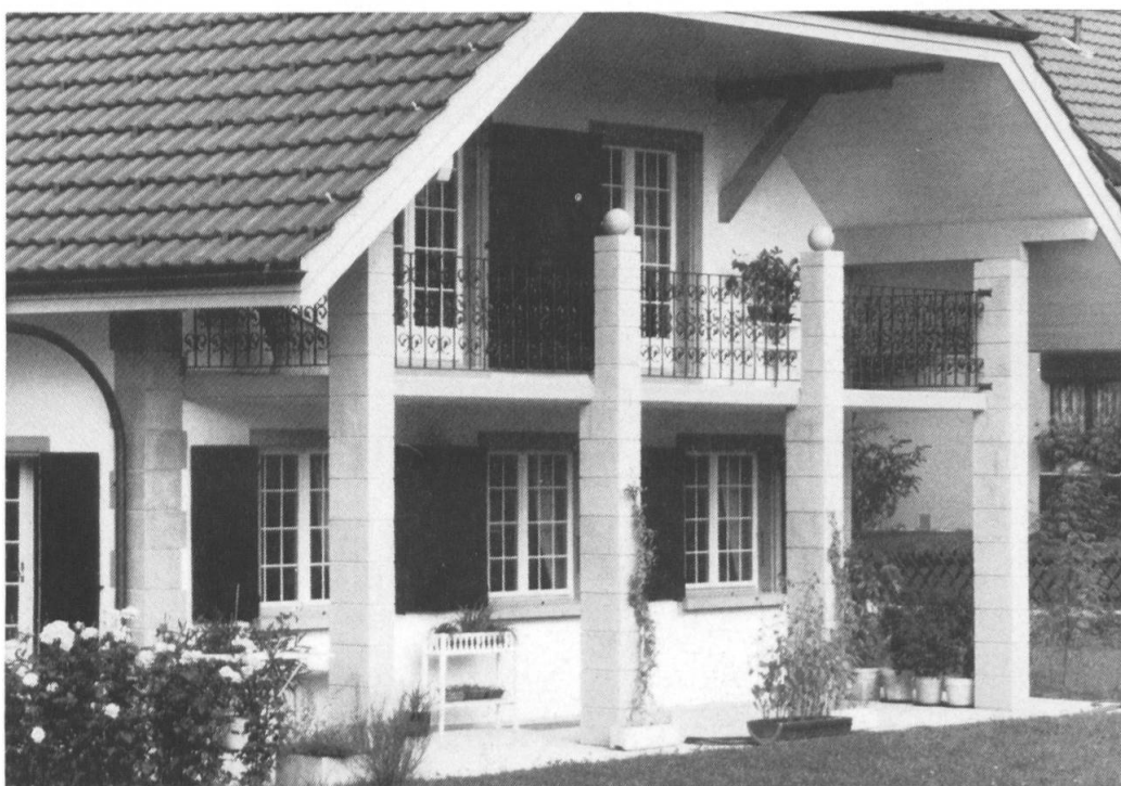
Einfamilienhaus Rapperswil BE 1985, Fenstereinfassungen, Lisenenplatten und Säulen aus Kunststein (Sandsteinimitation geschliffen).
