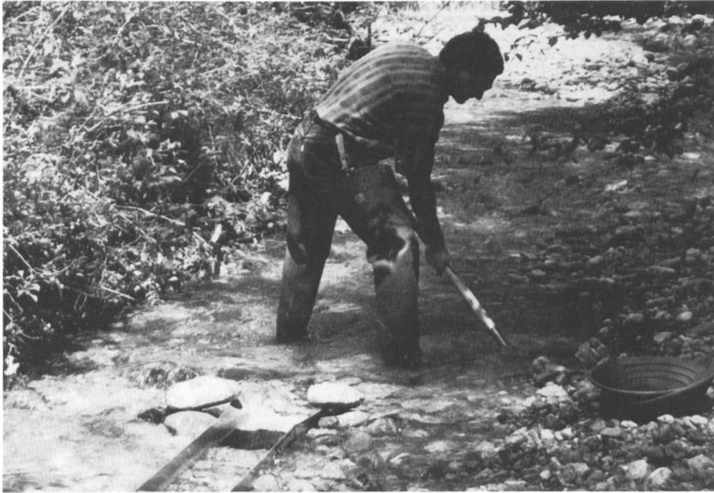
Zu den wichtigsten Geräten eines Goldwäschers gehören heute die Schleuse, ein Aluminiumkännel mit eingelegtem Teppich (vorne), sowie die Waschpfanne aus Plastik (rechts).
