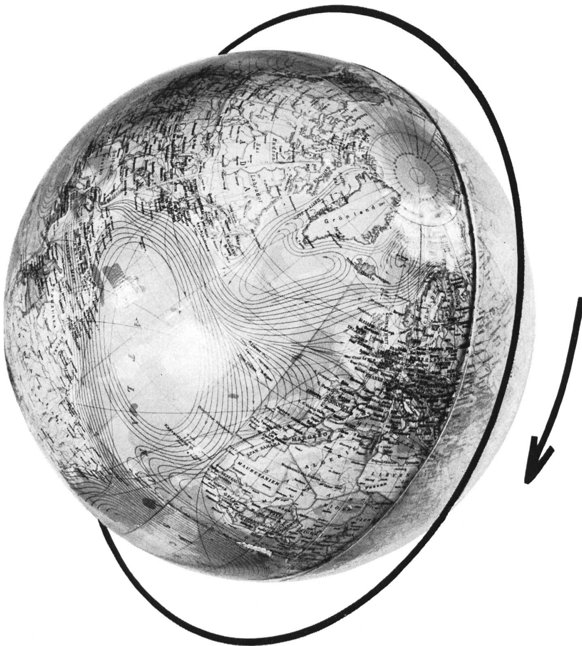
Abb. 5 Ein Globus mit Subsatellitenbahn und Schablone zur Bestimmung des Bildausschnitts
