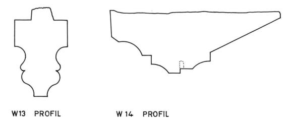
Abb. 13 Burgdorf, Stadtkirche. Grabung 1968/69. Werkstücke aus dem Umbau von Bau I. W 13: Gewölberippe, W 14: Fenstergewände. Maßstab 1:20 Text S. 28 ff.
