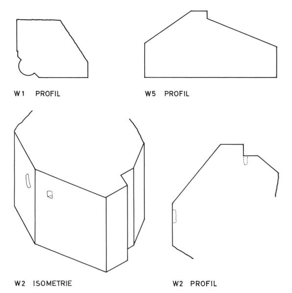
Abb. 12 Burgdorf, Stadtkirche. Grabung 1968/69. Werkstücke aus Bau I. W 1: Türgewände, W 2, W 5: Fenstergewände, Maßstab 1: 20. Text S. 26 ff.
