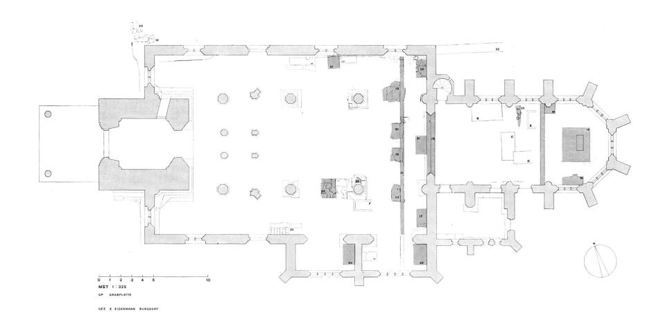
Abb. 17 Burgdorf, Stadtkirche. Grabung 1968/69. Plan der Bodenbefunde zur heutigen Kirche 1471/90 (G 2a), Maßstab 1:325. Ausstattungsfundamente dunkel getönt. Stufe im Schiff und Altar im südl. Seitenschiff ergänzt. Legenden zu den Nummern siehe Abb. 2.
