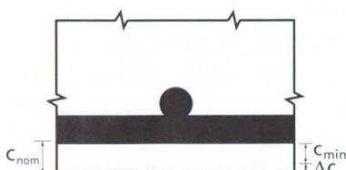
Fig. 2 Enrobage nominal  $c_{nom} = c_{min} + \Delta c$ .
