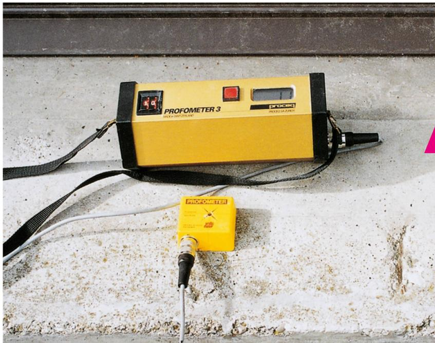
Mesure de l'enrobage d'un rebord de fenêtre dégradé par la corrosion.
