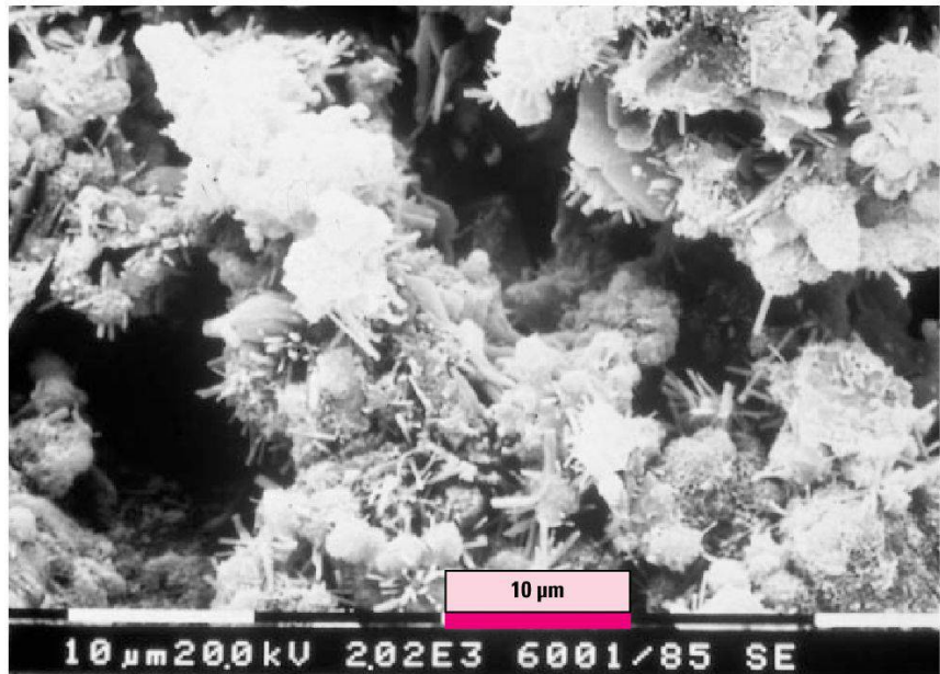
Fig. 2 Le gel de ciment se compose de produits d'hydratation enchevêtrés, en aiguilles ou plus gros.
