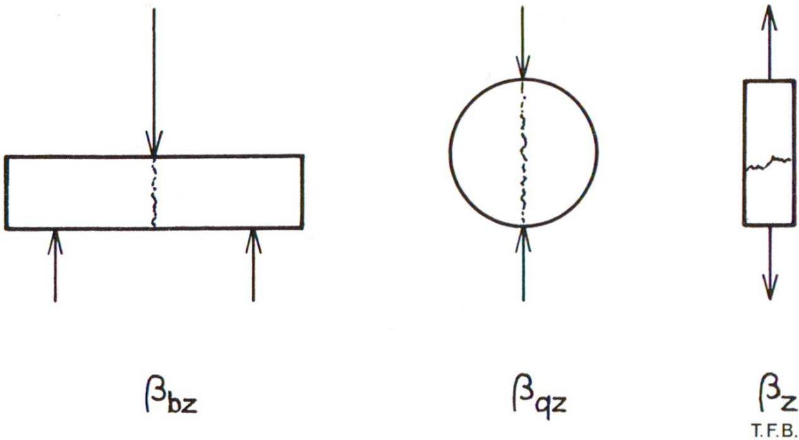
Fig. 1 Trois genres de résistance du béton à la traction: Résistance à la traction par flexion  $\beta_{bz}$ , résistance à la traction par fendage  $\beta_{qz}$ , résistance centrée  $\beta_z$ . Représentation schématique des forces.
