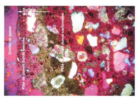
Action des sulfates sur la pâte de ciment durcie d'une paroi de canalisation (lame mince, lumière polarisée plus lame de gypse, largeur de la coupe 2,4 mm).
