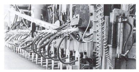
Fig. 3 Les goujons sont placés ou introduits par vibration dans les joints transversaux, mécaniquement.
