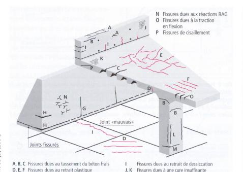
Fig. 3 Les fissures de retrait ne sont qu'une des sortes de fissures qui peuvent se former dans les éléments d'ouvrage en béton en fonction de facteurs tels que la conception architecturale, la réalisation et les sollicitations (selon [19]).
