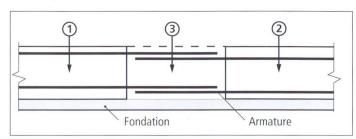
Fig. 8 Les brèches de clavage (③) sont un moyen efficace pour empêcher les fissures dues au retrait de dessiccation si elles sont laissées ouvertes suffisamment longtemps [selon [23]).
