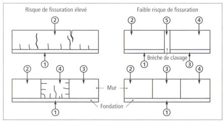
Fig. 7 L'ordre des différentes étapes de bétonnage ( $\mathbb{D} \to \mathbb{S}$ ) a une grande influence sur la formation de fissures de retrait (selon [23]).
