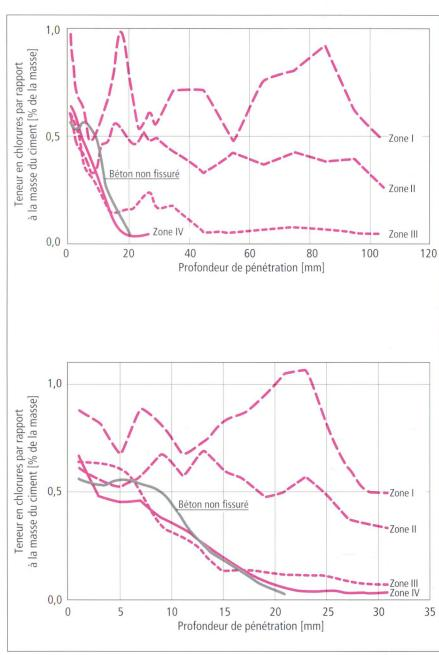
Fig. 4 Teneur en chlorures totale en fonction de la profondeur de pénétration et de la distance latérale des flancs des fissures d'un béton (e/c = 0,50) avec largeur des fissures de 0,1 mm (en haut) ou de 0,4 mm (en bas) après 24 heures. Absorption d'une solution à 3% de chlorure de sodium (selon [20]). (Distance latérale des flancs des fissures: zone I = 0-5 mm, zone II = 5-10 mm, zone III = 10-20 mm, zone IIV = 0.5 mm.)
