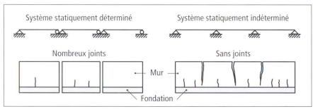
Fig. 6 Diminution du risque de fissuration grâce à des mesures de conception (selon [23]).
