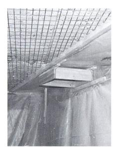
Pour l'essai de qualification du béton projeté pour le renforcement d'une dalle, les «caisses» ont été fixées à la dalle et le béton a été projeté verticalement depuis le bas.
