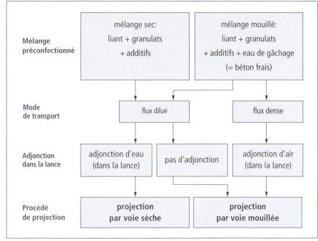
Fig. 2 Techniques du béton projeté (selon [5], légèrement modifié).
