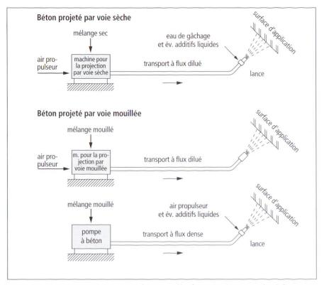
Fig. 1 Représentation schématique des procédés de projection par voie sèche et par voie mouillée (selon [5]).
