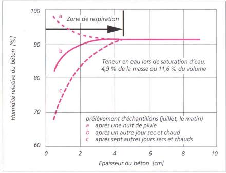
Fig. 2 Influence de l'environnement sur la teneur en eau d'un môle à Héligoland (calculée sur des carottes), selon [5].
