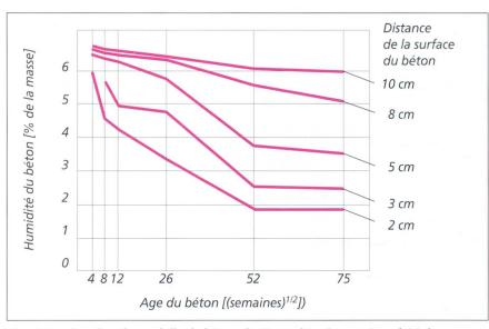
Fig. 4 Dessiccation d'une dalle de béton de 20 cm d'épaisseur, étanchée dessous et latéralement (B 25) à 50–60 % d'hum. rel. et 20 °C [7].
