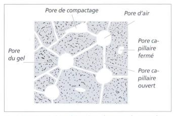
Fig. 1 Représentation schématique des types de pores dans la pâte de ciment durcie. Dessins: TFB
