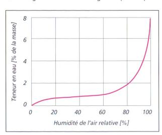
Fig. 3 Isotherme de sorption typique du béton [2].
