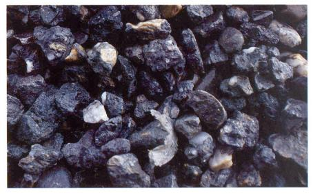
métriques sont en règle générale remplacées par des granulats de recyclage. On utilise pour la fabrication et la mise en place les mêmes machines que pour les bétons routiers traditionnels. L'utilisation de granulats de recyclage exige toutefois davantage d'expérience et un plus grand soin que celle de granulats «neufs».
