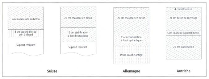
Fig. 2 Types de superstructures en Suisse [10], en Allemagne [6] et en Autriche [4].
