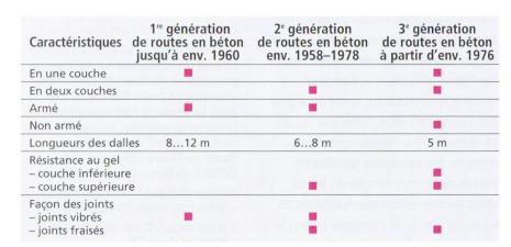
Tab. 1 Caractéristiques des types de revêtements en béton que l'on trouve en Suisse.
