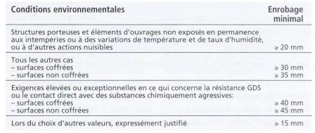
Tab. 1 Enrobage minimal de l'armature passive de structures porteuses et d'éléments d'ouvrage selon norme SIA 162 (sans majoration!) [1].
