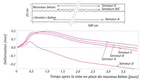
Fig. 2 Preuve des interactions entre «ancien» et nouveau béton au moyen de senseurs Sofo (selon[1]).
