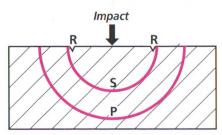
Fig. 3 Représentation schématique des ondes générées par un impact sur un élément d'ouvrage [2, 5].
