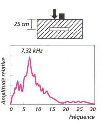
Fig. 5 Spectres de fréquences pour une dalle en béton de 0,50 m d'épaisseur (à gauche) ainsi que pour une dalle de même épaisseur présentant un vide à 0,25 m de profondeur (selon[8]).
