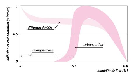
Fig. 5 Vitesse de diffusion de CO<sub>2</sub> et vitesse de carbonatation en fonction de l'humidité de l'air [1].
