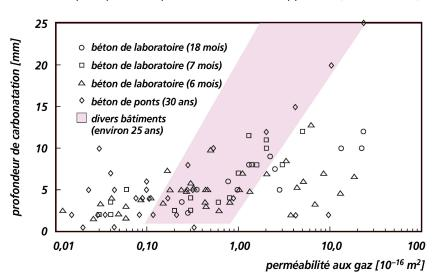
Fig. 4 Carbonatation en fonction de la perméabilité aux gaz [10].
