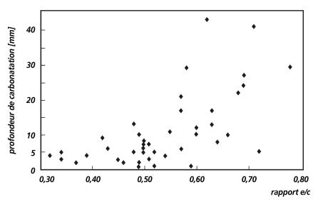
Fig. 3 Influence du rapport e/c sur la carbonatation du béton dans des ponts ayant jusqu'à 68 ans [8].
