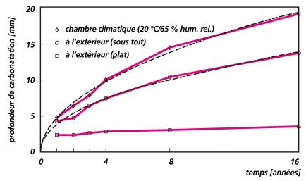
Fig. 6 Evolution de la profondeur de carbonatation dans le temps. La ligne tiretée correspond à l'évolution selon la loi  $\sqrt{t}$  [11].
