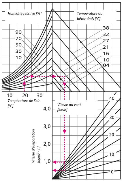
Fig. 1 Estimation des influences des températures du béton frais et de l'air, de l'humidité relative ainsi que de la vitesse du vent et de la perte d'humidité sur la surface non protégée du béton. Dans l'exemple donné (température du béton 20 °C, humidité relative 50 %, température de l'air 20 °C, vitesse du vent 20 km/h), la perte d'eau est de 0,5 kg/m² par heure. Source: [2], modifié.
