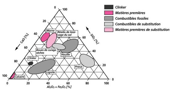
Fig. 1 Diagramme de Rankine du clinker ainsi que des matières brutes primaires et secondaires (de substitution) pour la fabrication du clinker [1].
