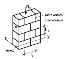
Fig. 1 Maçonnerie de parpaings avec sollicitations et système d'axes;  $N_x$  = effort normal,  $M_z$  = moment de flexion selon l'axe z,  $h_o$  = hauteur d'assise (hauteur d'une brique, plus joint d'assise),  $l_o$  = longueur d'une brique, plus largeur du joint vertical (selon [1]).
