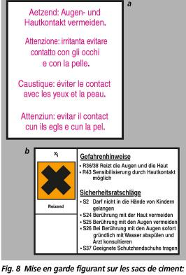
Fig. 8 Mise en garde figurant sur les sacs de ciment: (a) en Suisse; (b) en Allemagne. On trouve également des informations concernant le travail avec du ciment dans les fiches de sécurité qui peuvent être demandées à toutes les cimenteries.
