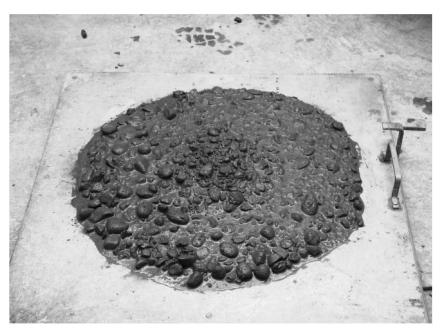
Béton ressuant sur la table à secousses.
