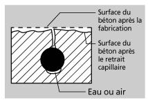
Fig. 2 Fissuration au-dessus d'une barre d'armature due au ressuage et au retrait capillaire.
