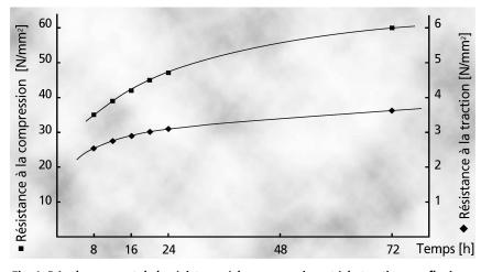
Fig. 1 Développement de la résistance à la compression et à la traction par flexion d'un béton de réparation à haute résistance initiale.
