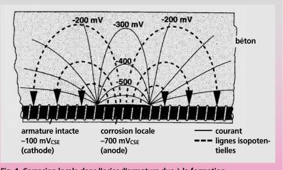
Fig. 1 Corrosion locale dans l'acier d'armature due à la formation de macro-éléments [5].
