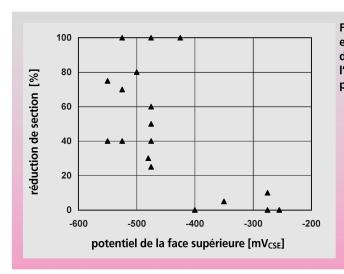
Fig. 3 Rapport entre la réduction de section de l'armature et le potentiel [4].
