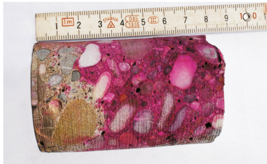
Vérification de la profondeur de carbonatation sur une carotte au moyen de phénolphthaléine.
