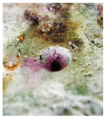
Détermination simple de la profondeur de carbonatation (test à la phénolphtaléine).
