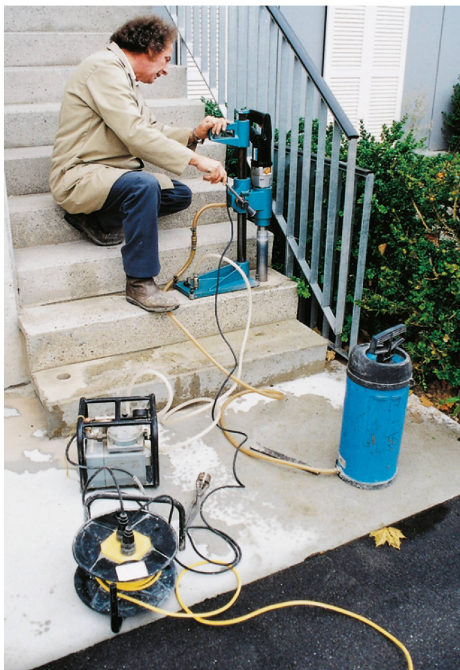
Prélèvement d'une carotte destinée à une investigation destructive.
