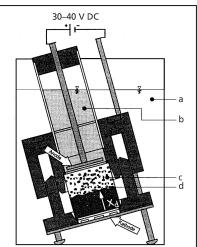
Fig. 1 Cellule de mesure pour la détermination de la résistance aux chlorures du béton (a: 3 % NaCl dans 0,2 m KOH; b: 0,2 m KOH; c: échantillon de mortier, h = 50 mm,  $\emptyset = 50$  mm; d: front de pénétration des chlorures).
