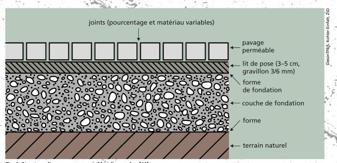
Fig. 1 Structure d'un pavage perméable à l'eau selon [11].
