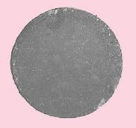
Echantillons de béton provenant d'un balcon de fuite avant et après l'essai de résistance aux sels de déverglaçage (100 cycles): en haut non traité, en bas imprégné selon le procédé décrit dans l'encadré à la page 5.
