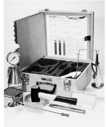
Appareil CM pour déterminer rapidement la teneur en eau des échantillons de béton.
